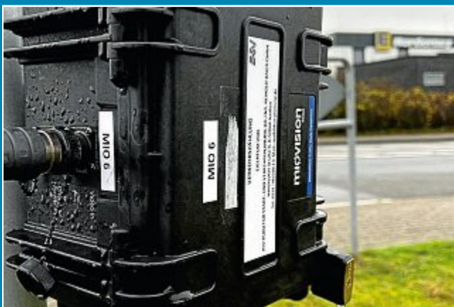
Auf Norderney wird wieder der Verkehrslärm gemessen. An einigen Stellen hängen für eine Woche diese elektrischen Geräte.
