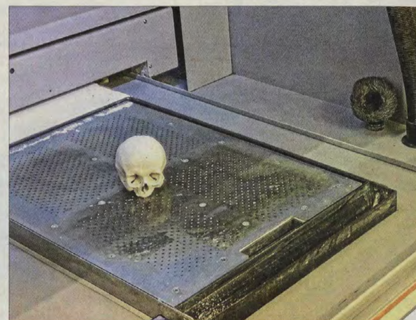
Blick in die Druckkammer des 3D-Druckers.
