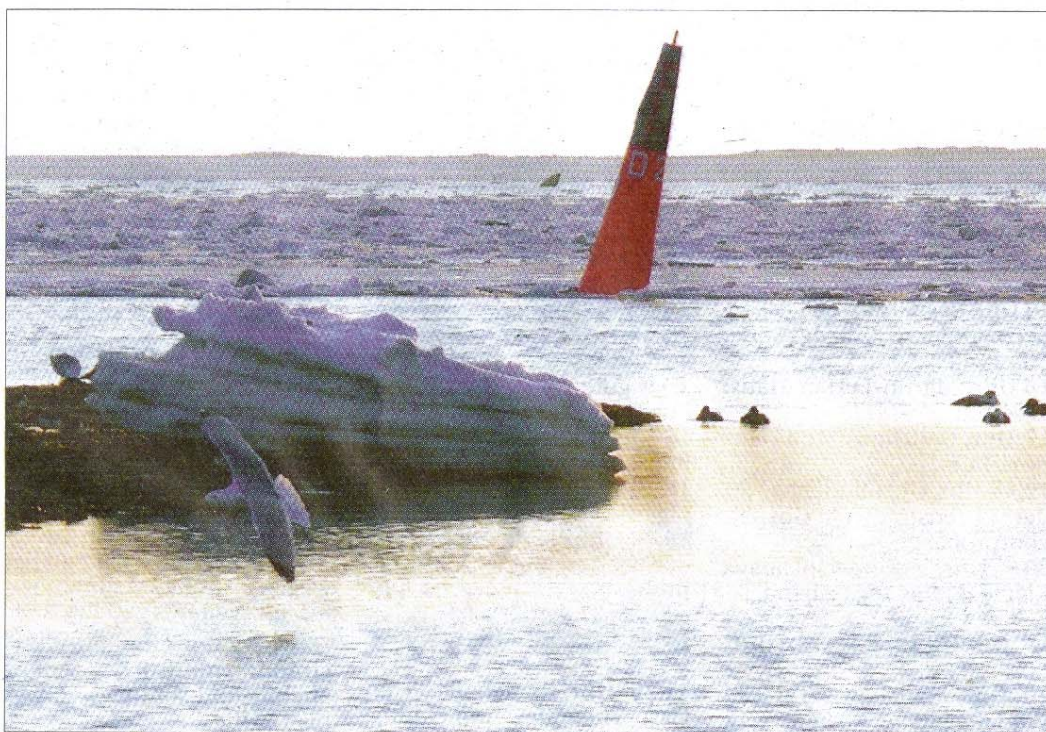
Eine rote Spierentonne vor dem Weststrand markiert das Fahrwasser. Kommen große Eismassen, duckt sich die Tonne und das Eis schwimmt darüber hinweg. FOTOS: RASS
