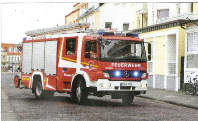
Das Hilfeleistungslöschfahrzeug 20-16 mit einem 2000-Liter-Wassertank im Einsatz.
