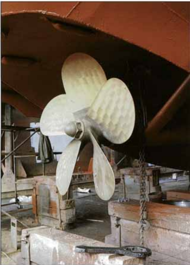
Der fünfblügelige Propeller der Hauptantriebs-schraube, mit dem alle FRISIA-Fährschiffe ausge-rüstet sind.
