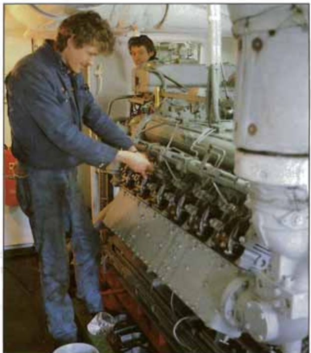
Wartungsarbeiten am 420 PS starken Dieselmotor eines Schottel-Antriebs.
