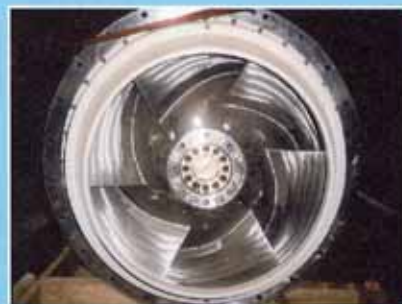
Blick in eine der Impellerpumpen
