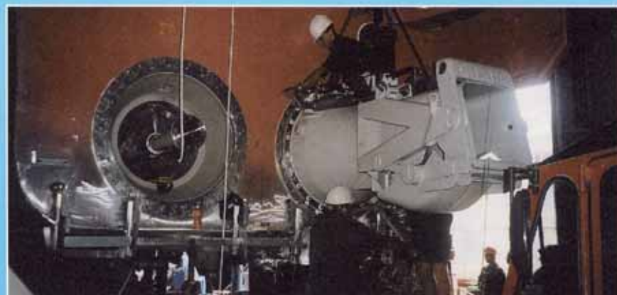
Montage einer der hydraulisch schwenkbaren Steuereinheiten
