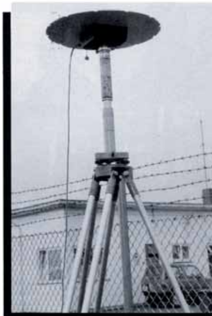
Die über einem Trigonometrischen Punkt installierte Satelliten-Empfangsantenne
