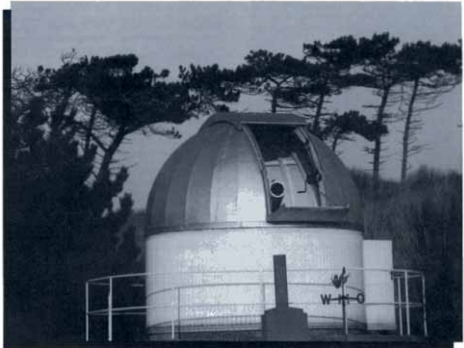
Die Kuppel ist drehbar, um das Teleskop nach allen Richtungen ausrichten zu können.
